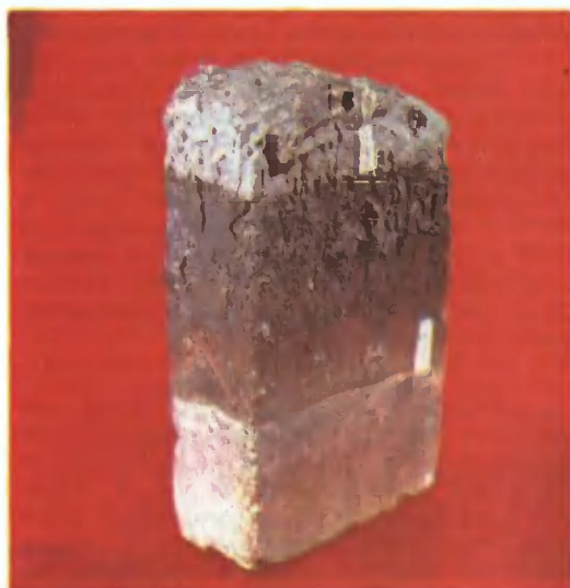
Натеки кристобалитовый на динасе из стекловаренной печи.
