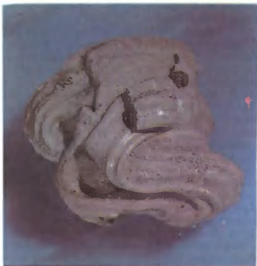
Натеки кристобалитовый на динасе из стекловаренной печи.
